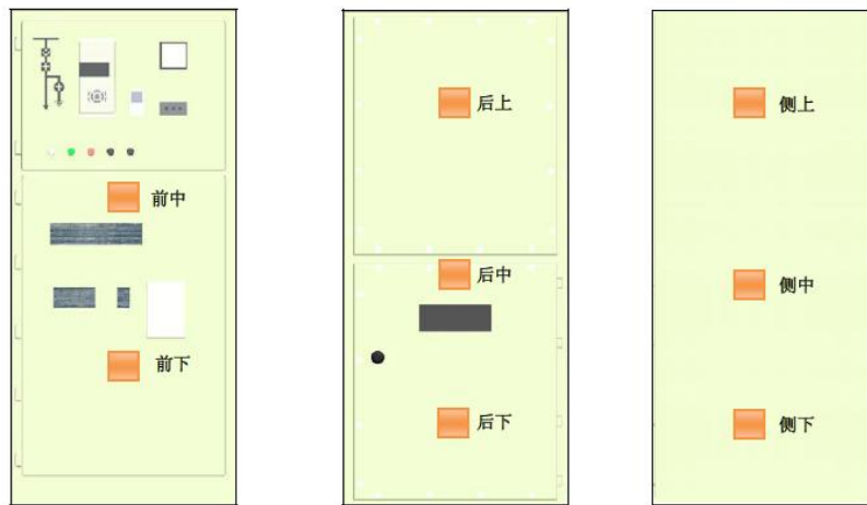
图 6-1 TEV 检测部位示意图
