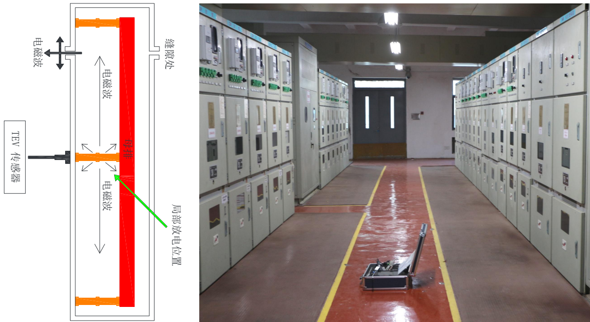
图 3-1 TEV 检测原理图
