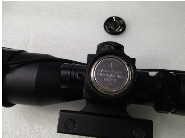
图 4 更换内部照明供电纽扣电池
