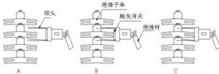
(3) 向前推动仪器，触发与绝缘子裙沿接触的测量开关，当听到“嘀”的提示音，测量完成，阻值已被保持，仪器即可离开绝缘子。
