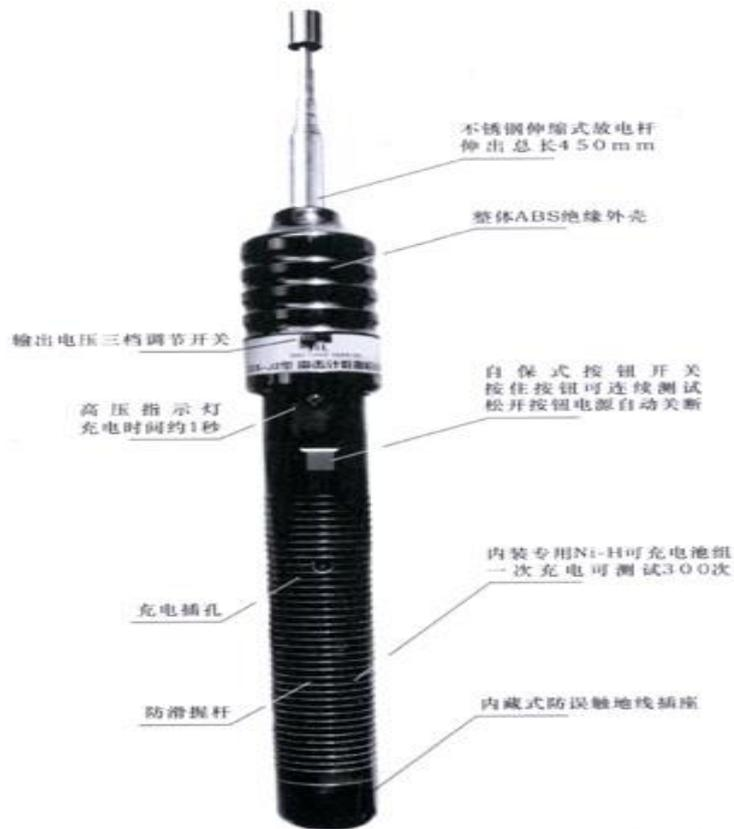
注意事项：每次使用前应该确保高压侧无高压（红灯未亮）才可将仪器天线拉出。旋转开关打开前确认仪器已经可靠接地。试验完毕后，先关闭电源，然后将头部导电杆对地线放电后，方可将仪器收起。
