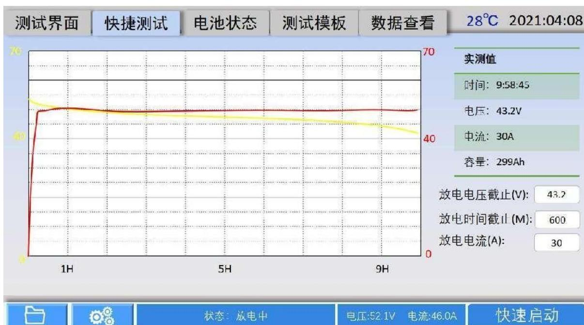
点击“快捷测试”界面，调用的测试模板直接会植入到该界面，设备连接好后，点击“快速启动”即可测试，如果想修改参数，可对放电电压截至，放电时间截至，放电电流进行修改。
