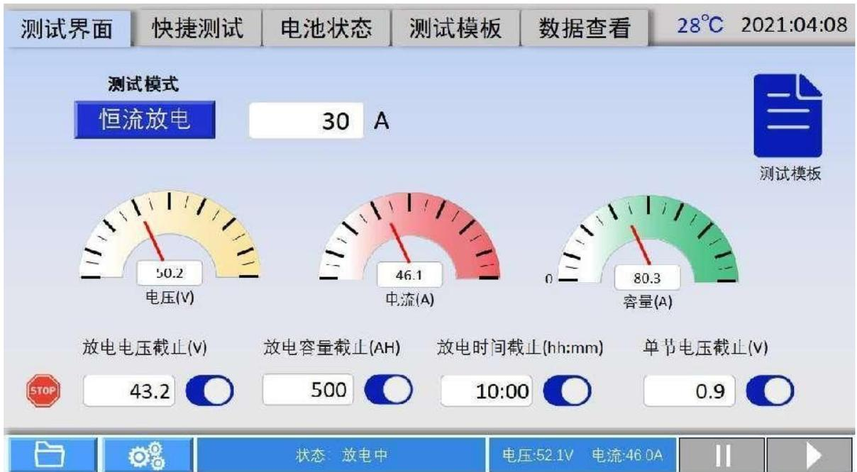
点击“测试界面”进入参数设置，点击“测试模式”下方按钮进行放电模式切换，并在右侧参数框内设置需要的放电电流。
