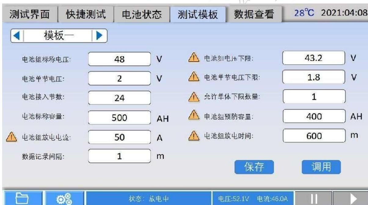
可通过点击“测试界面”的“
