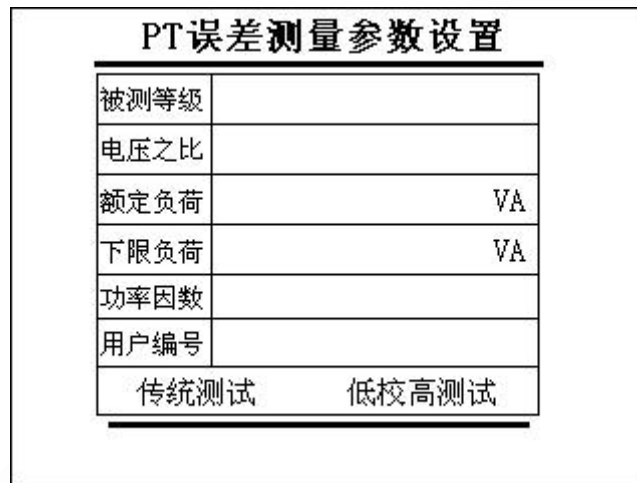
图 6-2 电压互感器(单绕组)测量参数设置
