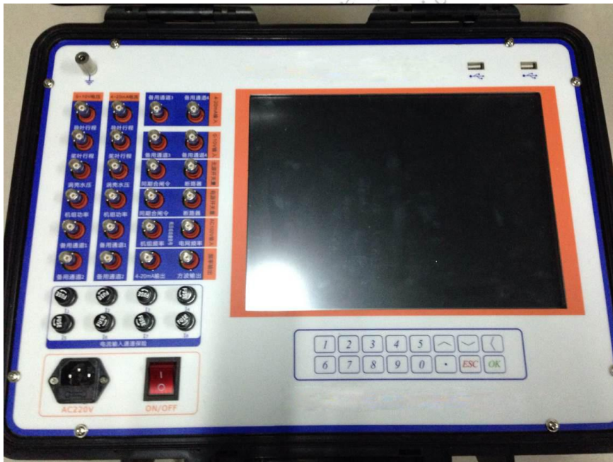
图 2.1 水轮机调速器仿真测试仪
