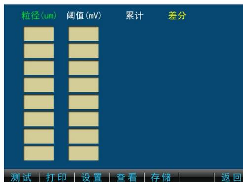
“测试”按钮进行通道校准测试；点击“设置”按钮进入通道校准设置功能，可以进行参数设置；点击“查看”按钮可以查看存储的校准点同时可进行校准操作。点击“存储”按钮可进行校准点的存储操作；点击“返回”按钮不保存并返回到校准主界面。
