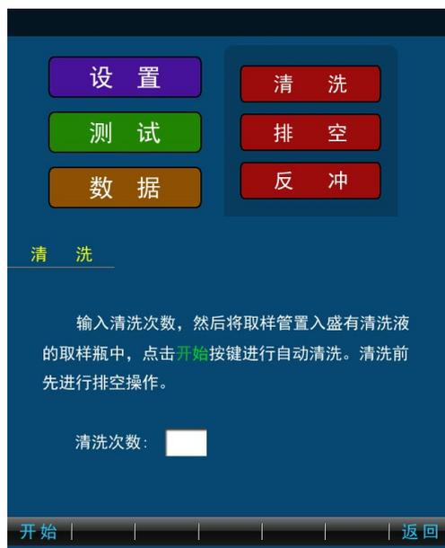
清洗界面，如图 7.6.1.1 所示。输入清洗次数（最多可设置 9 次），点击“开始”按键后仪器将按照设置的清洗次数进行清洗操作。清洗过程中提示“清洗中...”，清洗完成后返回到清洗界面。清洗过程可点击“结束”按键结束清洗。
