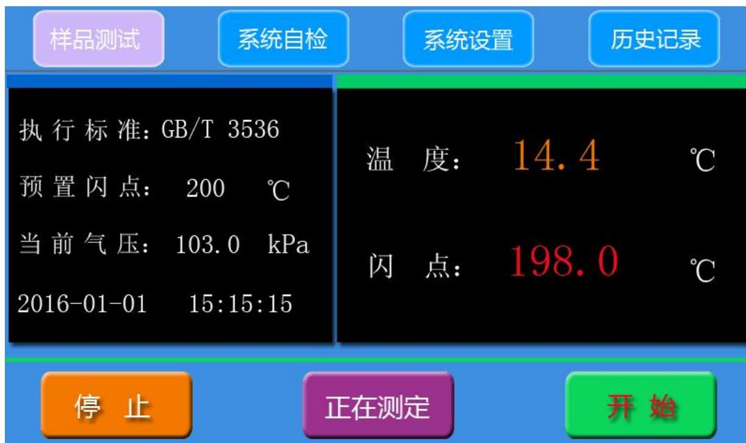
点击“开始”，升降杆落下，开始测试并有一个正在测定的提示图片；点击“终止”，停止试验，升降杆升起同时提示图片消失。
