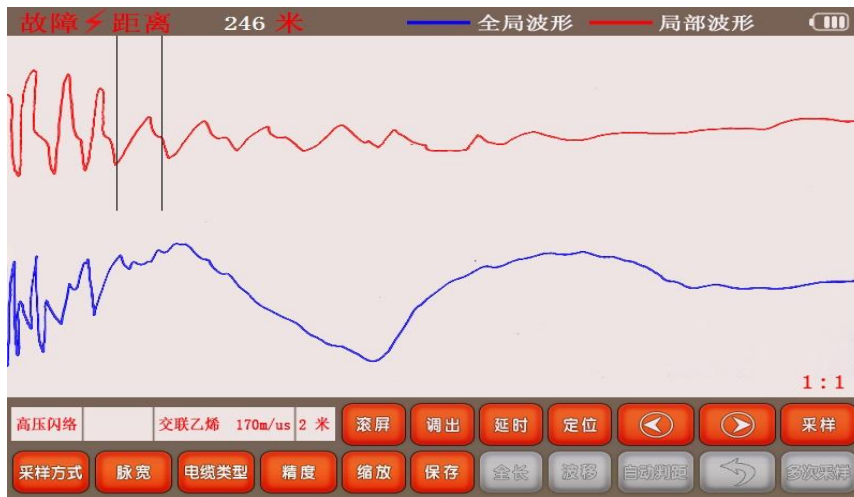
冲击闪络法测试波形示例
